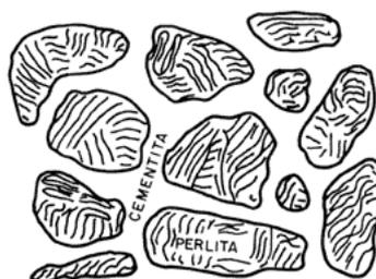
**Figura 9. Simulación de una metalografía de un acero con estructura de granos de perlita embebidos en una matriz de cementita.**
